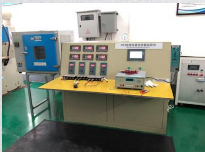
单相三相继电器电寿命、短路电流综合测试台
